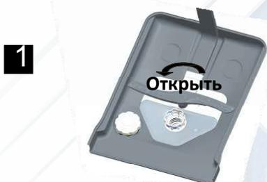
1. Поверните фильтр против часовой стрелки.
